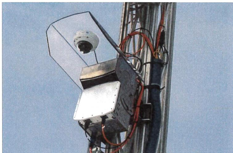
Figura 9: Radar AVYX con tettuccio di protezione e webcam (Geoprävent AG)
